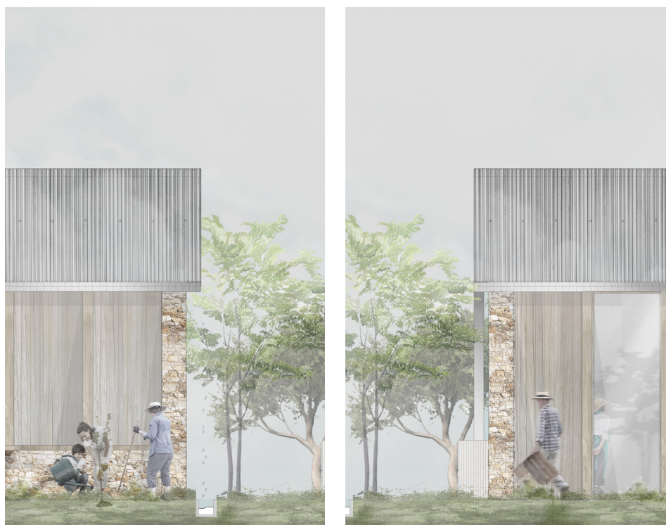
Fig. 41. Le fil de l'eau du faitage à la rive de toiture jusqu'au sol // extrait de façades
